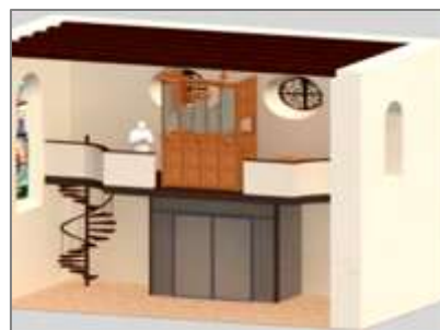
Schéma du projet d'installation de l'orgue sur une tribune au fond de la chapelle, au-dessus de la porte principale
